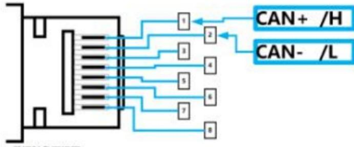
注：上图为网口通讯信号针定义图，输入/输出一样
